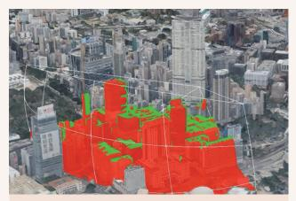
3D UR Planner可模擬單位視域,進行三維空間研究。圖中 的綠色部分代表在特定大廈單位內,可望到的景觀範圍。 3D UR Planner enables planners and architects to conduct 3D viewshed analysis of a designated unit. The visible area from the given location is indicated in green.
